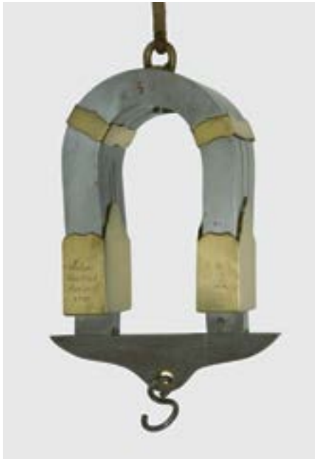
114 Johann Dietrich, «Diederichscher Magnet», 1755. — Daniel Bernoulli liess 1755 im Rahmen seiner Studien zum Magnetismus beim Basler Goldschmied Johann Dietrich (1715–1758) einen hufeisenförmigen Magneten anfertigen. Anhand des Objekts stellte er Beziehungen zwischen der Tragkraft eines Magneten, seiner Oberfläche und seinem Gewicht her.
